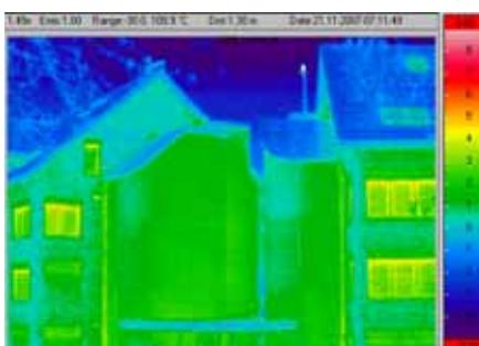
Bild rechts: Den Beweis für die Aussage zu Bild links liefert Bild rechts: Hier sind die Bedingungen für die IR-Aufnahmen gut, denn die Temperaturen des Vortages waren nur wenig höher als zum Zeitpunkt der IR-Aufnahme, so dass die Wärmeabgabe des Betonturmes infolge Speicherverhalten geringer war.
